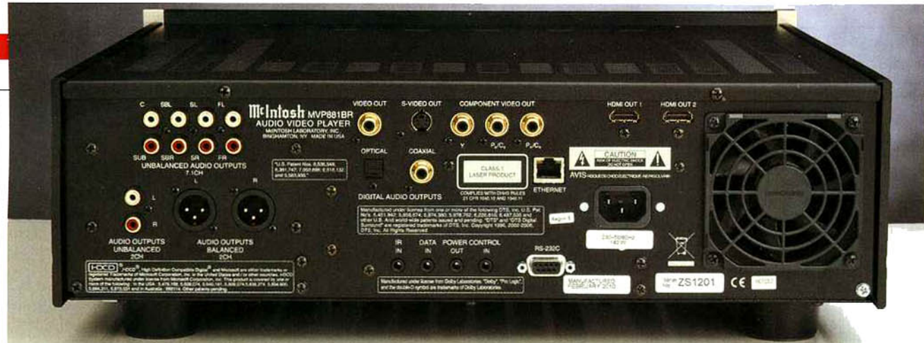
Essendo un lettore audio-video, l'MVP881 offre un'ampia varietà di connessioni: CVBS, S-Video, Component ed HDMI per la sezione video, audio multicanale e stereo analogico, anche in versione bilanciata, presa Ethernet ed una serie di mini-jack per il multiroom e per l'accensione dell'intera catena di riproduzione.
